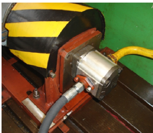
Obr. 1 Zubový hydrogenerátor typu UD 25, ktorý je namontovaný v skúšobnom zariadení
